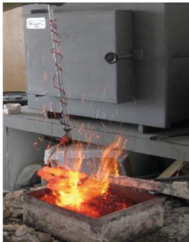
Figura 4. Extracción de las muestras de acero de la caja para posteriormente ser templadas en aceite mineral.
