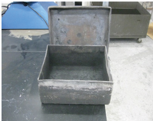
Figura 2. Muestra la caja metálica donde se colocaron las muestras de acero AISI 1018, y la mezcla de carbón vegetal y carbonato de bario, una vez rellena, fue tapada, sellada con arcilla e introducida al horno para su tratamiento.
