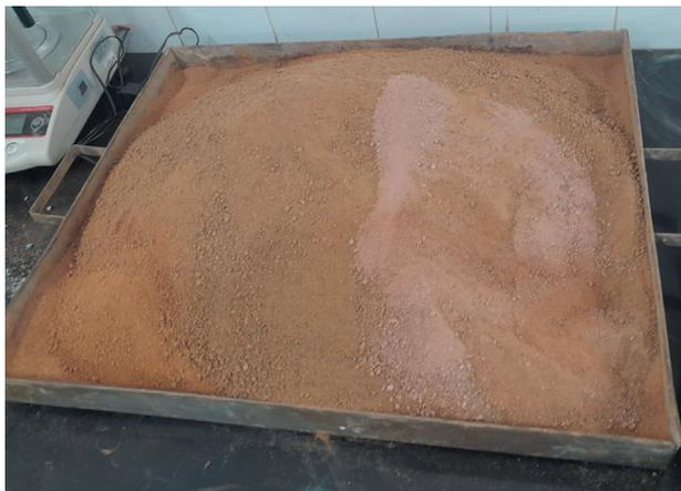
Figura 4 - Solo utilizado na confecção dos tijolos
