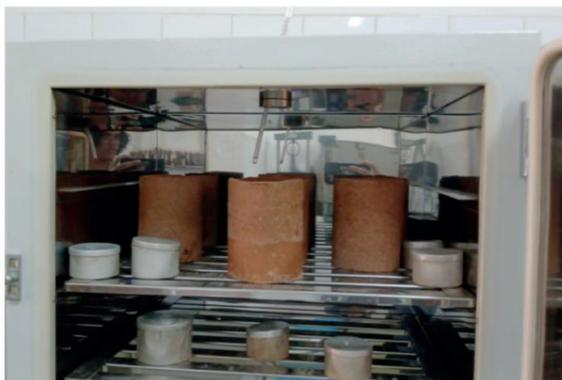
Figura 14 - Amostras em estufa para secagem
