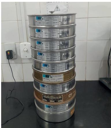
Figura 9 - Peneiras utilizadas no ensaio de granulometria
