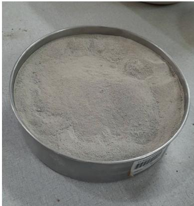
Figura 3 – RCD após peneiramento na peneira de 0,15 mm
