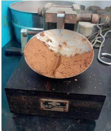
Figura 7 - Ensaio do limite de liquidez
