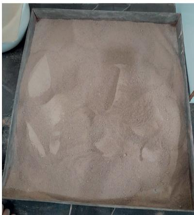
Figura 10 - Mistura de solo-cimento sem adição de RCD
