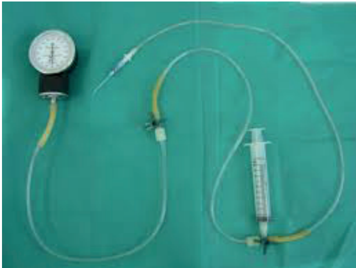
Figura 3 – Circuito para aferição da pressão arterial media com manômetro aneroide
