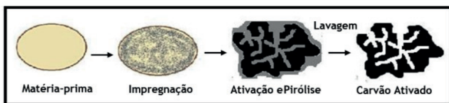
Figura 1 – Esquema ilustrativo do processo de obtenção do carvão ativado
