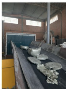
Processo para triturar as borras de poliestireno.
