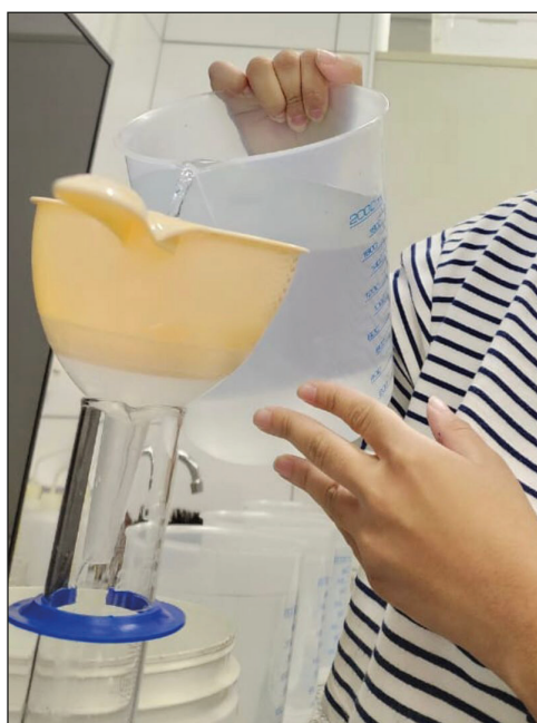
FIG 3- Remoção das impurezas físicas da água retirada do aparelho do ar condicionado
