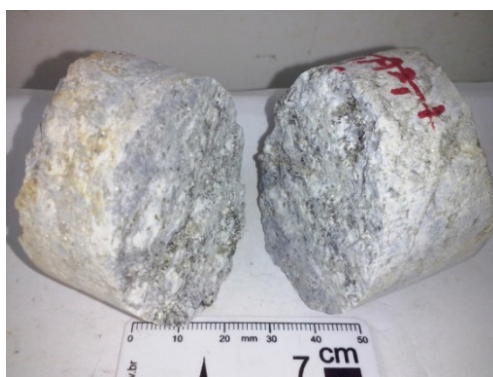
(a) – Ensaio diametral válido.
