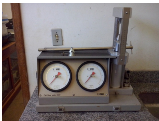
Figura 2 - Aparelho para realização de ensaios PLT.
