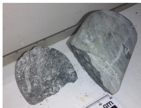
(b) – Ensaio diametral inválido.
