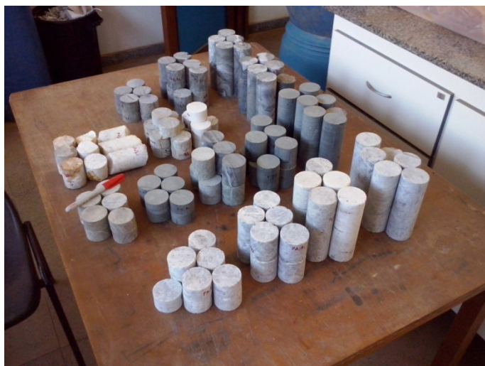
Figura 1 - Amostras utilizadas nos ensaios de resistência à carga pontual e compressão simples.
