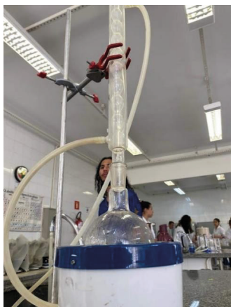
Figura 4: equipamento de refluxo
