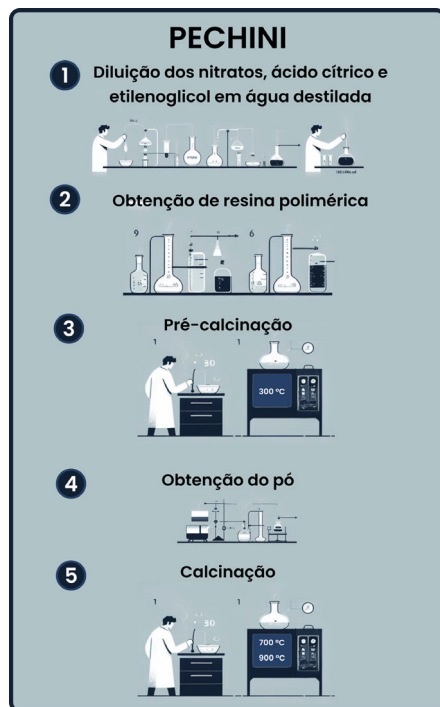
Figura 1. Fluxograma explicativo sobre o método Pechini
