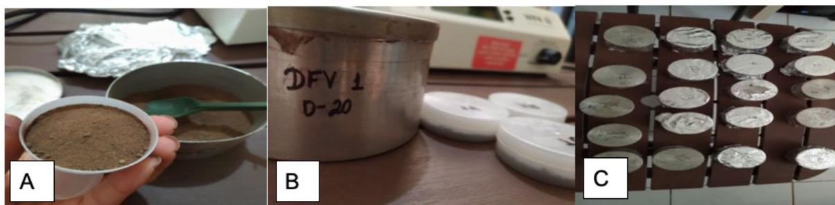
Figura 1. Procedimentos realizados: A – Produção de subamostras, B – Cadinho metálico com duas respectivas subamostras, C – Amostras analisadas.
