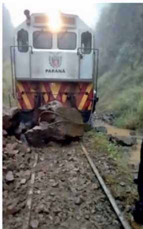
Figura 20 - Locomotivas paradas devido a bloco rochoso que desabou sobre a ferrovia
