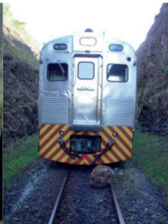
Figura 20 - Locomotivas paradas devido a bloco rochoso que desabou sobre a ferrovia
