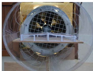
Figura 26 Vista frontal de acoplamiento de segunda cámara de prueba al túnel de viento para que se pueda analizar el modelo a escala.
