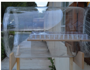
Figura 27 Vista frontal de acoplamiento de segunda cámara de prueba al túnel de viento para que se pueda analizar el modelo a escala.
