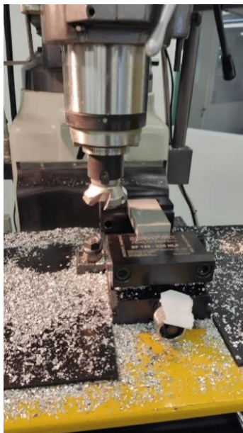
Figura 25 - Processo de usinagem do bloco de alumínio.
