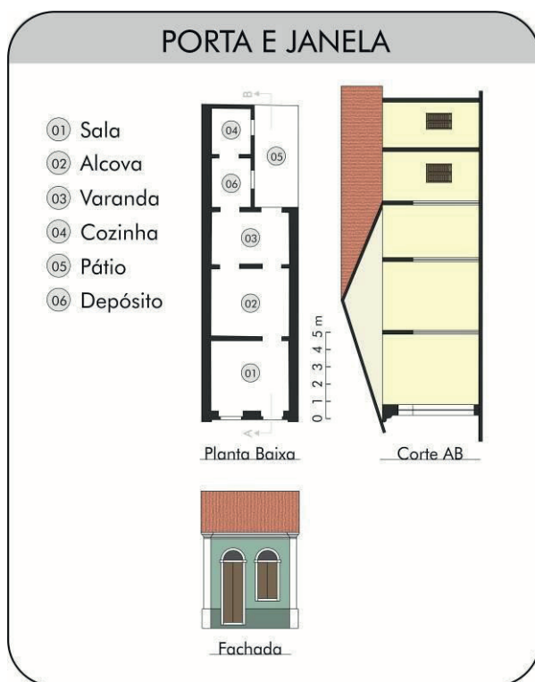
Figura 6: Desenho esquemático de fachada, corte e planta baixa de uma porta-e-janela. Fonte: Adaptado de Silva Filho, (1998).
