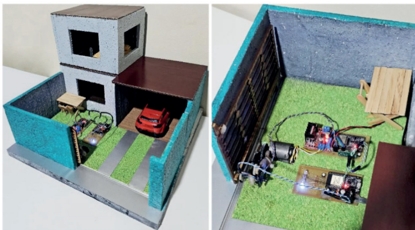
Figura 5 - Hardware ligado na réplica do portão eletrônico.
