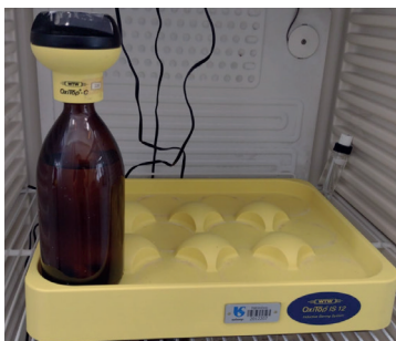
Figura 28- Conjunto garrafa e sensor eletrônico
