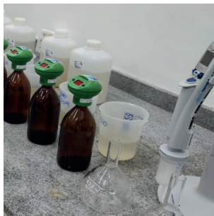
Figura 27 - Preparação do ensaio de DBO
