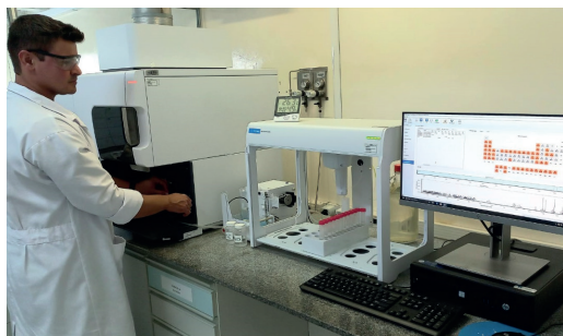
Figura 30 - Técnico realizando a leitura das amostras no ICP-OES
