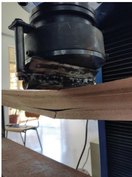
Figura 5 - Momento de ruptura da peça ensaiada a flexão da MLC de Eucalyptus urograndis .
