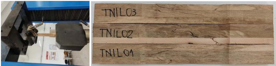
Figura 7 - Ensaio a tração da MLC de Eucalyptus urograndis e corpos de prova que mostram as linhas de ruptura
