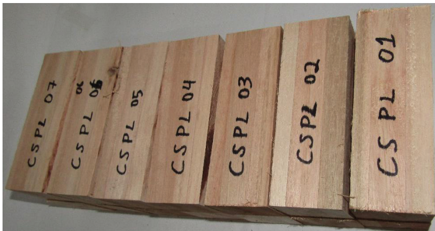
Figura 9 - Amostra para ensaio de compressão simples paralela às fibras da MLC de Eucalyptus urograndis .
