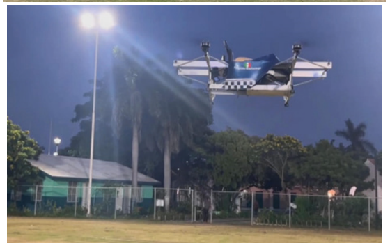
Figura 5 Pruebas del hexacóptero con tripulación
