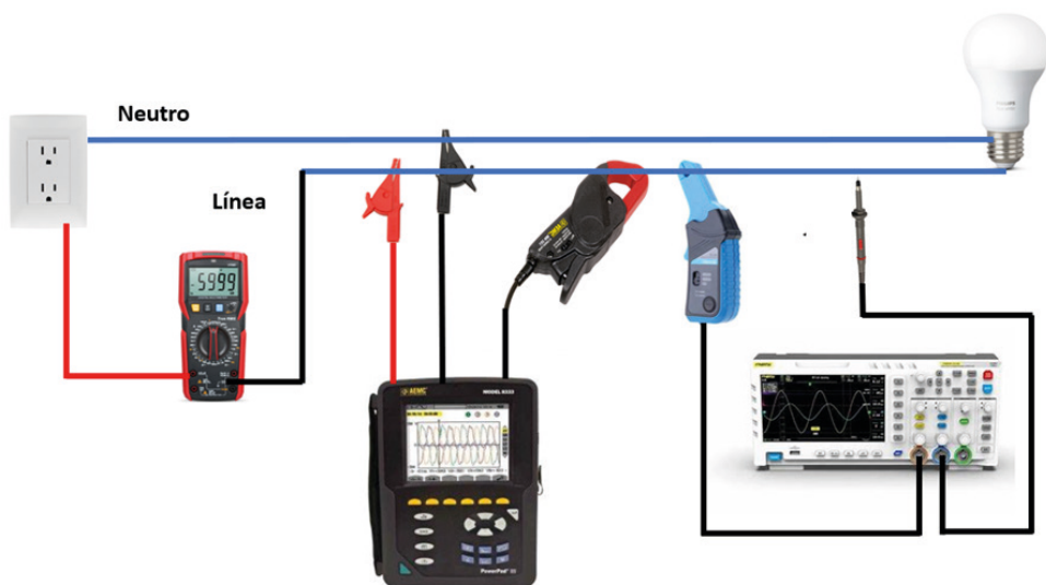
Figura 7. Diagrama de conexiones del banco de prueba para el estudio de la calidad de energía en las lámparas LED.
