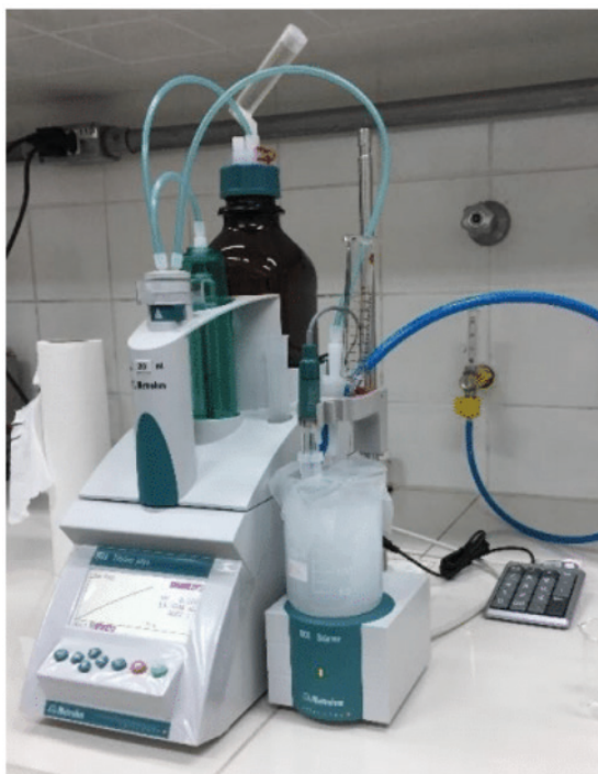
Figura 3. Titulador automático Titrino 702 SM QMetrohm durante a síntese de HDL.
