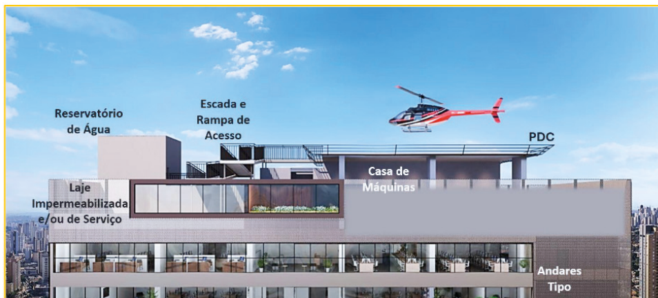
Figura 2 – Croqui em corte de perspectiva de PDC com suas características. Fonte: internet
