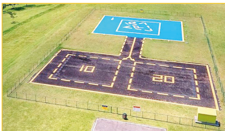
Figura 7 – Heliponto padrão ao nível do solo com FATO em azul no formato retangular. Fonte: internet
