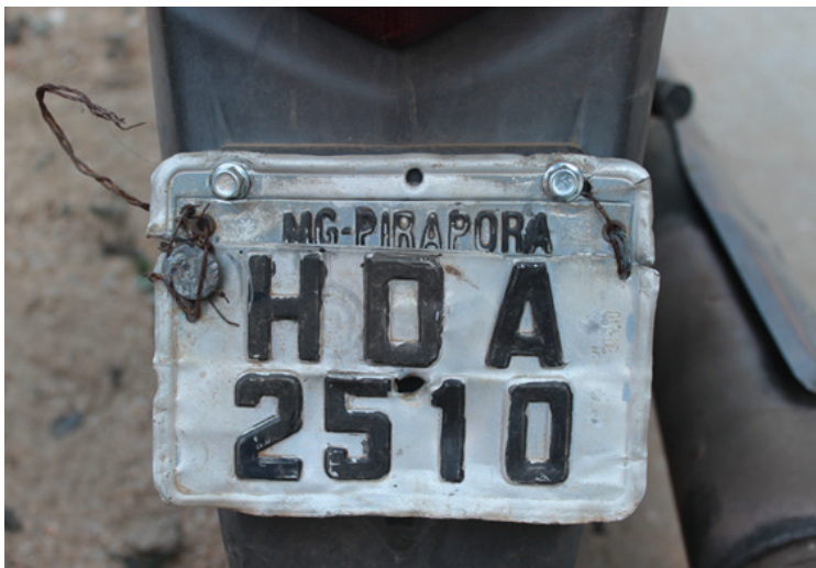
Figura 02. Placa de identificação veicular manifestando estrutura e lacre de segurança rompidos.
