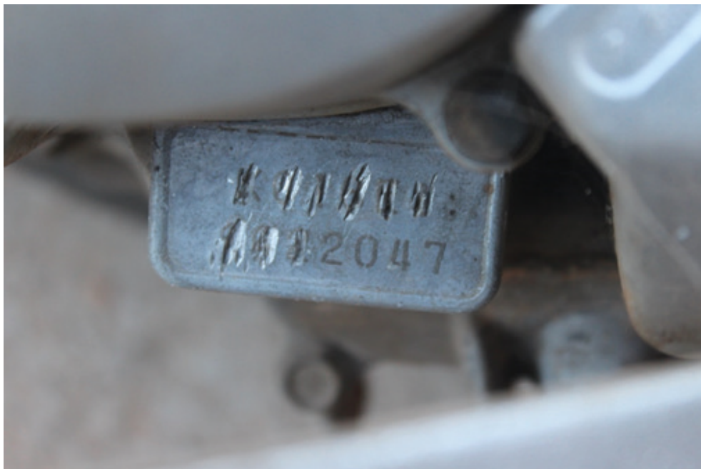
Figura 04. Supressão parcial da sequência alfanumérica do motor veicular.
