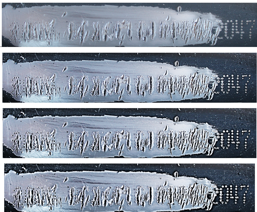
Figura 07. Evidenciação do NIV após aplicação do ácido (2009)9C2KC16109R022047)
