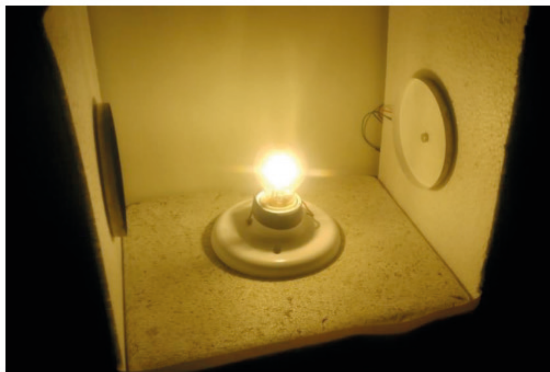
Figura 4: montagem experimental para estudo da transferência de calor por radiação.
