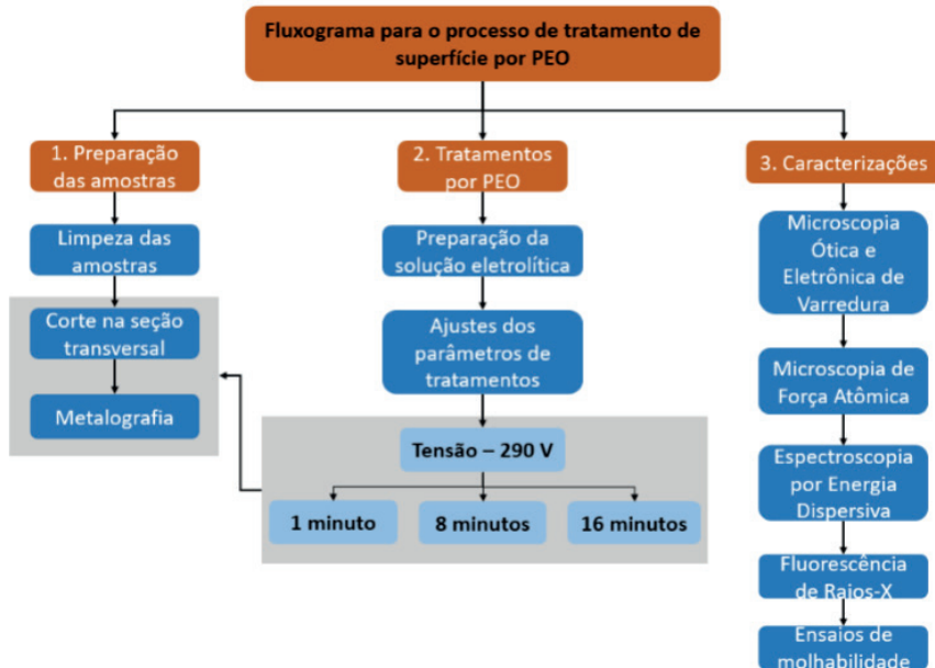
Figura 1 – Fluxograma com o processo para tratamento de superfície por Oxidação por Plasma Eletrolítica. Autoria própria (2018)
