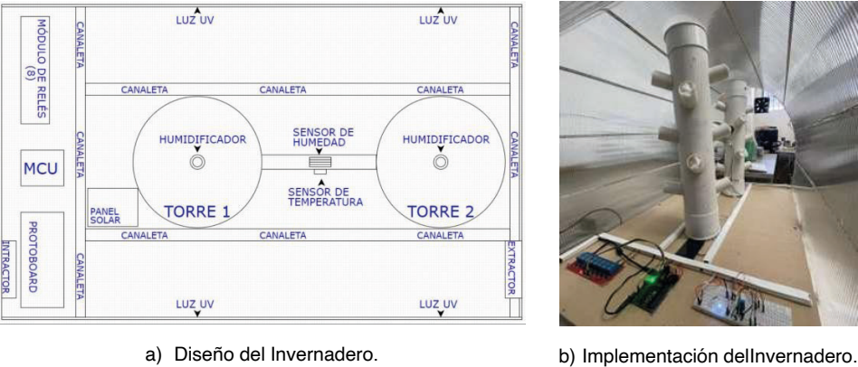
Figura 8. Diseño e implementación de la maqueta del invernadero.
