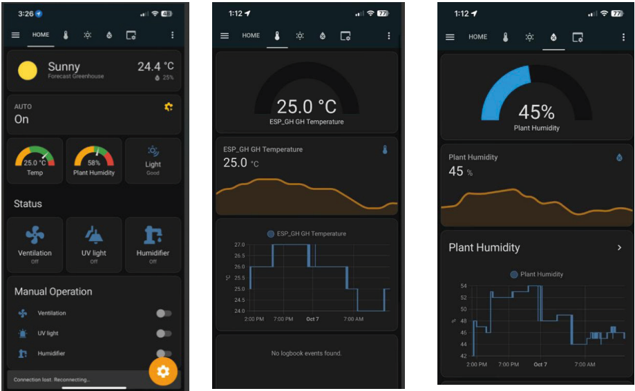
a) Panel principal del HA. b) Registro de temperatura dentro del invernadero. c) Registro de humedaddentro de los tubos.
