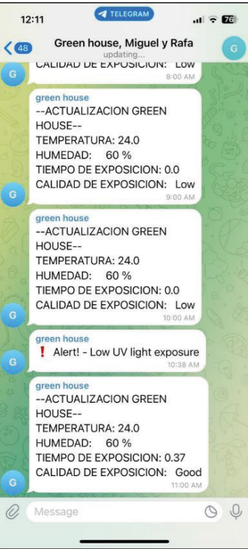
Figura 6. Interacción con el bot del Invernadero en Telegram para la monitorización de las principales variables físicas.
