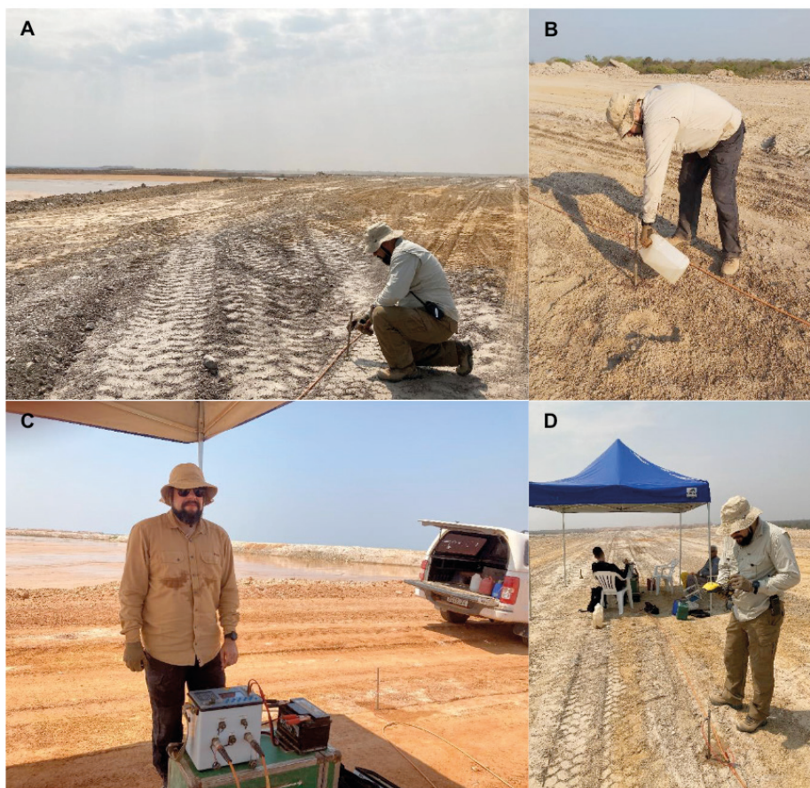
Figura 7. Preparação e montagem dos perfis (A). Umidificação dos pontos de cravação dos eletrodos com solução salina para redução da resistência de contato (B). Equipamento montado e pronto para a realização das injeções de corrente e realização das medições de resistividade (C). Coleta das coordenadas UTM de localização dos eletrodos ao longo do perfil (D).
