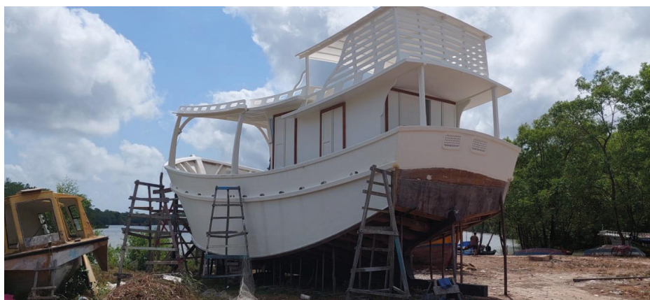
Figura 4. Lancha com o casco de plástico-alumínio revestido de fibra.
