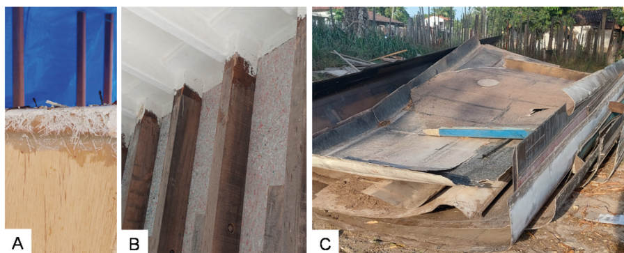
Figura 3. A. Fibras de vidro e resina sobre a madeira, B. placas de reciclados de plástico-alumínio e revestimento de fibra de vidro na parte superior, e C. placas de teto de ônibus.
