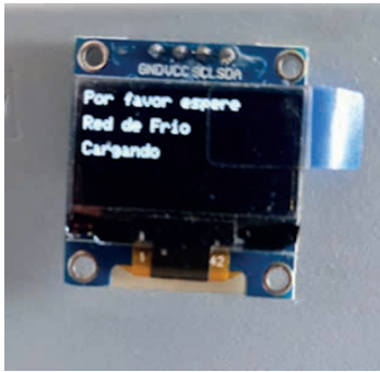
Figura 5. Pantalla de dispositivo externo de Prototipo IoT con mensaje de intento de conexión a Wi-Fi. Fuente propia.
