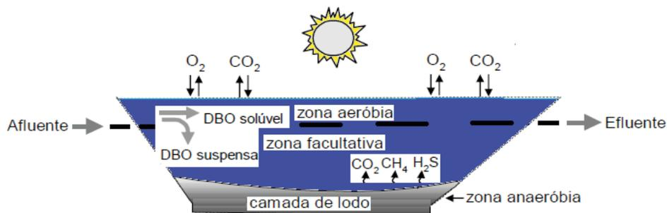
Figura 1 - Esquema simplificado de uma lagoa de estabilização (VON SPERLING, 1996)
