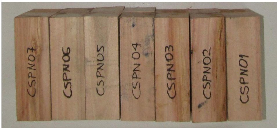
Figura 14 - Corpos de prova para ensaio de compressão simples da madeira paralela às fibras.
