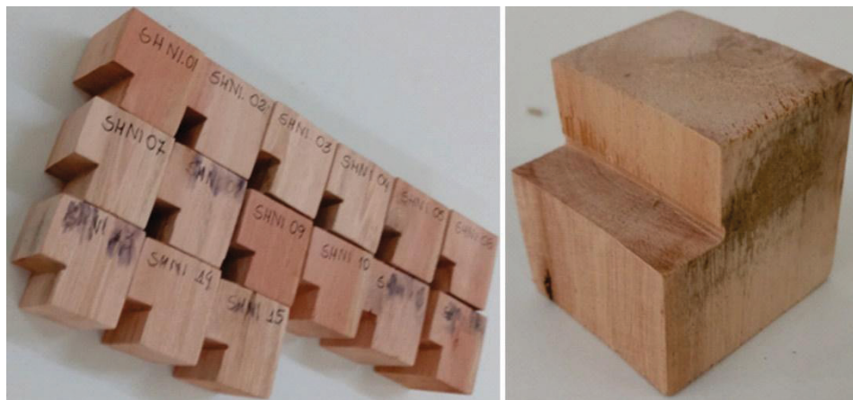
Figura 10- Corpos de prova para ensaios de cisalhamento da madeira natural de Eucalyptus urograndis
