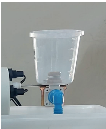
Figura 5 – Reservatório de solução concentrada junto a solenoide
