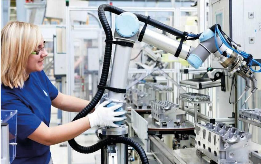
Figura 1– Exemplo de Robô Colaborativo (COBOT)
