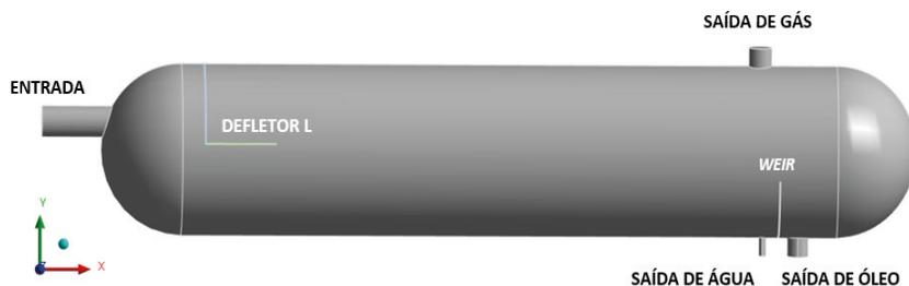
Figura 1- Geometria do vaso separador trifásico com defletor em L
