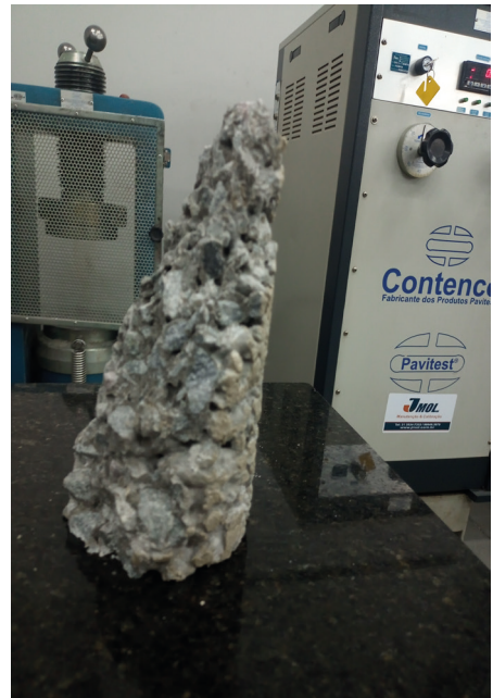
Figura 12 – Corpo de prova cisalhado Fonte: Próprio autor (2023)
