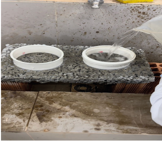
Figura 13 – Ensaio do coeficiente de permeabilidade Fonte: Próprio autor (2023)
