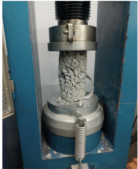
Figura 10 - Ruptura do corpo de prova Fonte: Próprio autor (2023)
