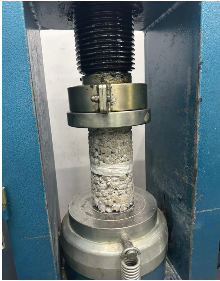
Figura 9 – Ensaio de resistência à compressão axial Fonte: Próprio autor (2023)
