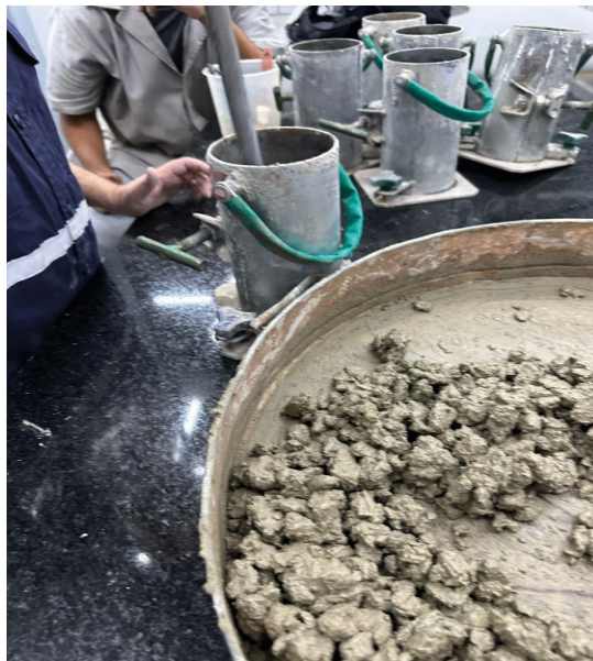
Figura 7 – Adensamento do concreto
