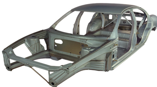
Figura 9. BIW obtenido como resultado del proyecto ULSAB
