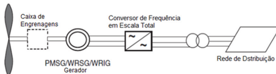
Figura 7 - Turbina eólica de velocidade variável completa com conversor de frequência em escala real TIPO D
