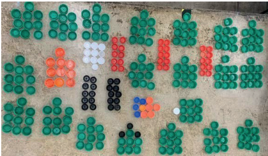
Figura 33 – Material necessário para confecção da telha
