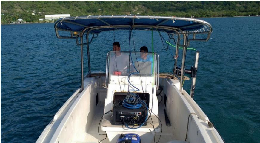
Figura 6 Embarcación tipo soundermax con ecosonda Kongsberg EM2040P.
