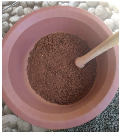
Figura 5 - Processo de destorroamento dos solos.
