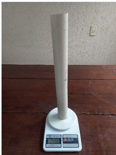
Figura 4 - Soquete para compactação.
