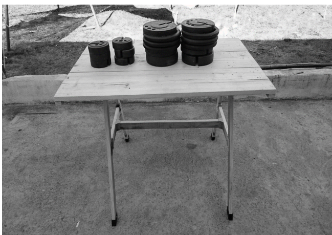
Figura 5: teste de carga com anilhas. Na imagem é possível ver 02 anilhas de 10kg, 10 anilhas de 05kg e 06 anilhas de 2,5kg, totalizando 85kg.
