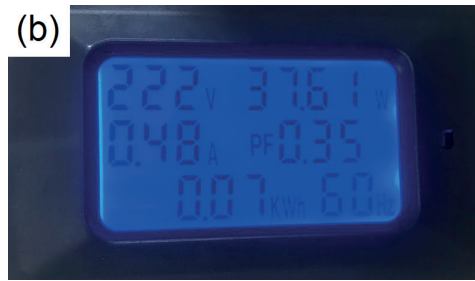
Figura 13: Medição de corrente, potência, tensão e fator de potência no transformador de 750 VA (a) e no transformador de 1500 VA (b).
