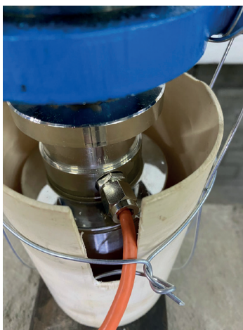
Figura 4. Célula de carga com suporte em PVC
