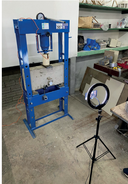
Figura 5. Prensa com a célula de carga
