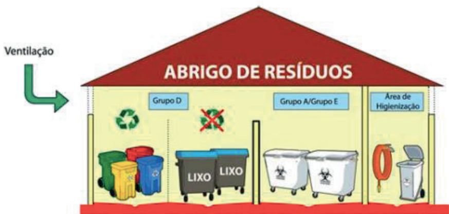
Figura 22 - Abrigo de resíduos dos grupos A, D e E.
