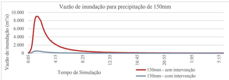
Figura 8 - Vazão de inundação para precipitação de 150mm
