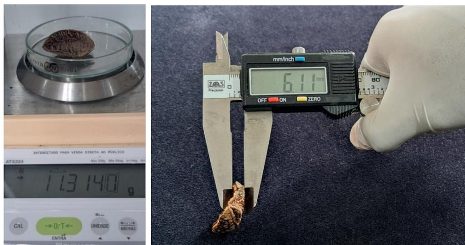
Figura 4. Determinação da massa e da espessura do tegumento externo de sementes em acessos de castanheira-do-brasil (*Bertholletia excelsa* Bonpl.).
