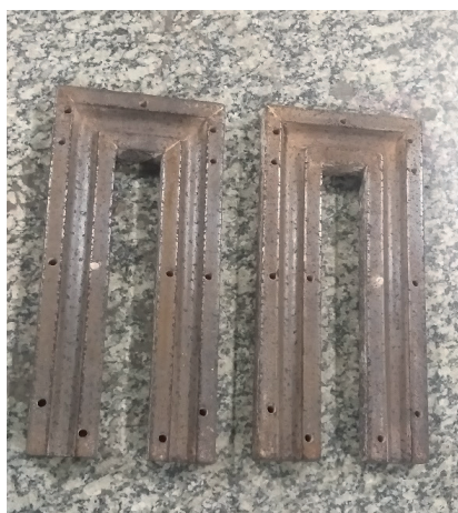
Figura 2 - Molde Metálico para o vazamento do banho metálico.
