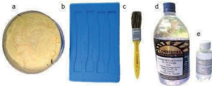
Figura 2: a) Cera Desmoldante b) Molde de Silicone c) Pincel d) Resina Poliéster e) Catalisador.
