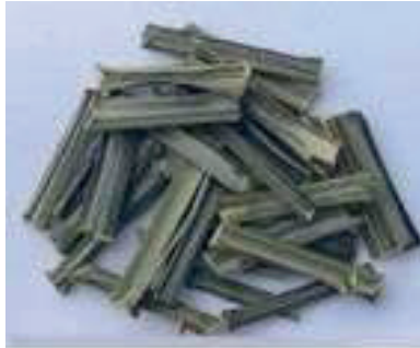
Figura 5- Fibras do pecíolo de dendê após o corte com 10 mm de comprimento.
