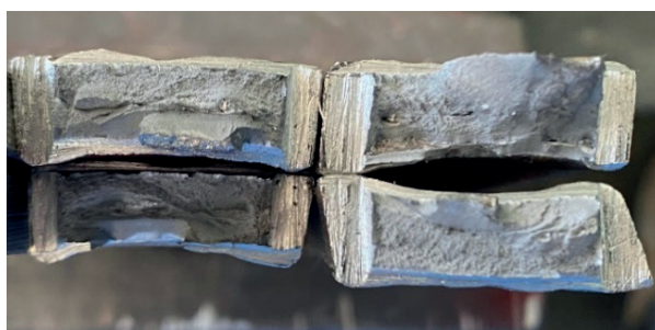
Figura 04 – Corpos de prova de Nick-Break após fratura
