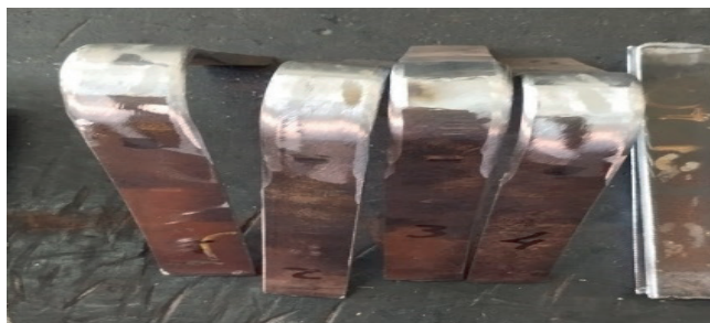
Figura 03 – Corpos de prova de dobramento
