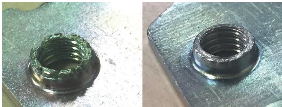
Figura 12: Condição do repuxo da liga 1 (C-Mn) foto à esquerda e liga 2 (Microligado) foto à direita.
