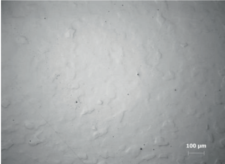
Figura 3: Foto da microestrutura da liga 2 (Microligado) com aumento de 100x sem ataque representando nível de inclusões D1F conforme classificação da ASTM(3).
