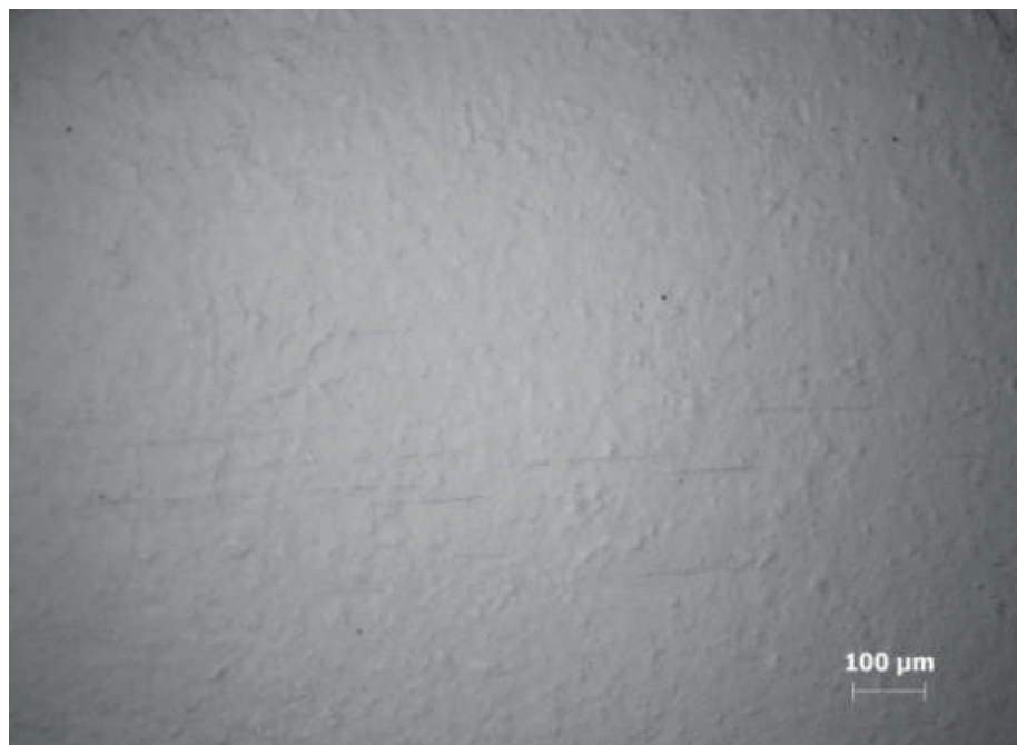
Figura 2: Foto da microestrutura da liga 1 (C-Mn) com aumento de 100x sem ataque representando nível de inclusões C1F conforme classificação da norma ASTM(3).
