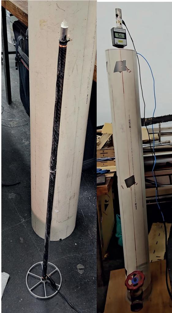
Figura 2 – Tubo de carbono experimental e forno de efeito Joule
